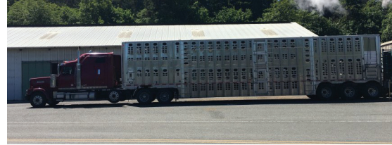
Remolque de dos pisos con caída central ('Potbelly')
